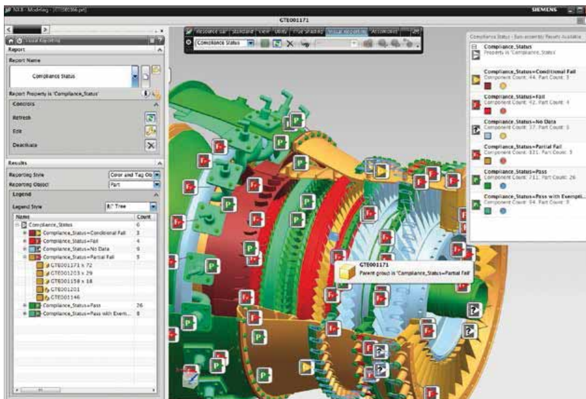
Фото 2. Несоответствия в привязке к конкретным элементам 3D-модели изделия
